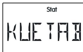
Odpojení kolektoru – nadměrná teplota je aktivní
