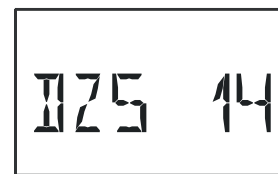
Drehzahlstufe Nur eingeblendet, wenn Drehzahlre- gelung PDR akti- viert (nur bei ESR21-D)
