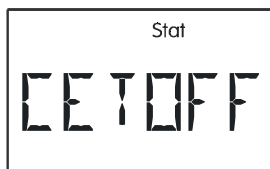
Colector – desconexión de exceso de temperatura está activada
