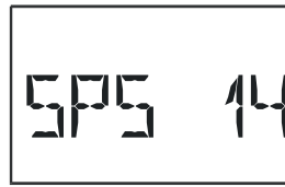
Livello velocità della pompa evidenziato solo per ESR21-D
