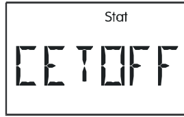
Keräimen ylikuumentemiskatkaisu on aktiivinen
