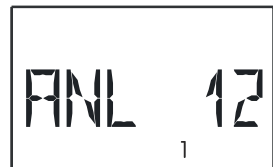
Analoginen taso Näytetään vain, kun ohjauslähtö on aktivoitu
