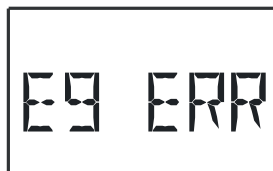
Ulkoinen arvo 9 Näytetään vain, kun ulkoinen datakaapeli on aktivoitu
