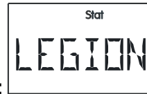
Keräimen ylikuumentemiskatkaisu tai legionellasuojaus aktiivinen (ei virhettä)
