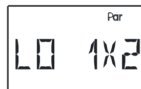
Ristikytkentä O1 ja O2
