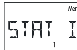
Virheilmoitus (virheen yhteydessä käänteinen vaihto 10 > 0V)
