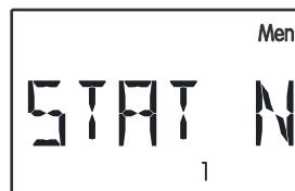
Virheilmoitus (virheen yhteydessä vaihto 0 > 10V)
