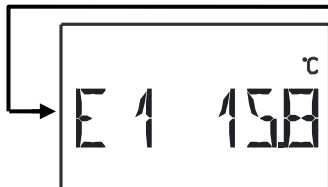
Ulkoinen arvo 1 Näytetään vain, kun ulkoinen datakaapeli on aktivoitu
