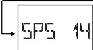
Pyörimisnopeus Näytetään vain, kun pyörimisnopeussäätö on aktivoitu
