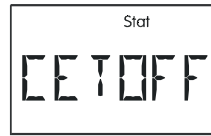
Keräimen ylikuumentemiskatkaisu tai legionellasuojaus aktiivinen (ei virhettä)
