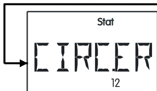
Virtausvirhe näytetään vain, kun se on aktivoitu
