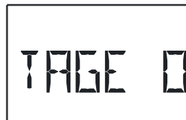
Zaštita od legionele Prikazuje se samo ako je aktivna funkcija zaštite od legion.
