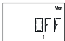
Uscita di comando disattivata
