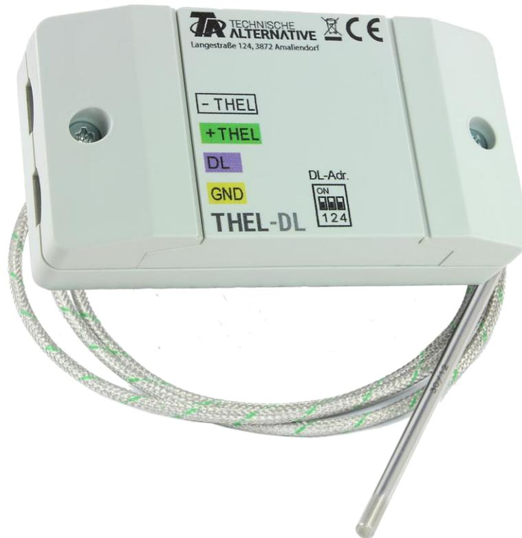
L'amplificateur de mesure du thermocouple a été développé pour l'acquisition de températures élevées en association avec des régulateurs de la société Technische Alternative. Il permet par exemple de mesurer la température des gaz brûlés dans un tube de fumée.
