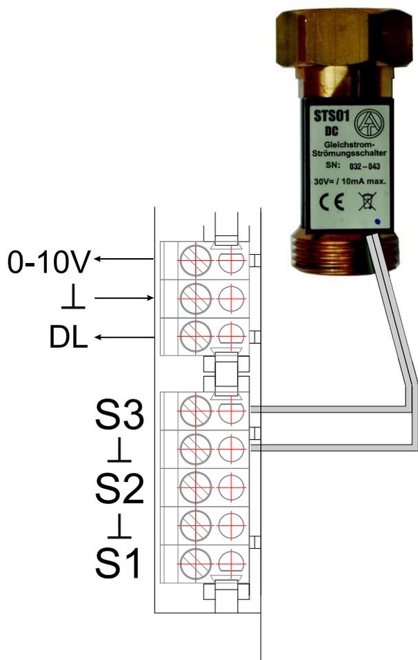
Il collegamento viene eseguito sempre a un'entrata sensore e alla massa sensore.
