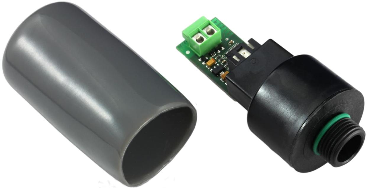
Il sensore di pressione PRS0-6DL serve per il rilevamento della pressione fisica. Si adatta in particolare per la determinazione di rapporti di pressione dell'acqua in circuiti di acqua di riscaldamento e dell'acqua industriale. L'elettronica dell'adattatore trasforma i valori di misurazione in un segnale digitale seriale adatto per il DL-Bus (Linea dati).
