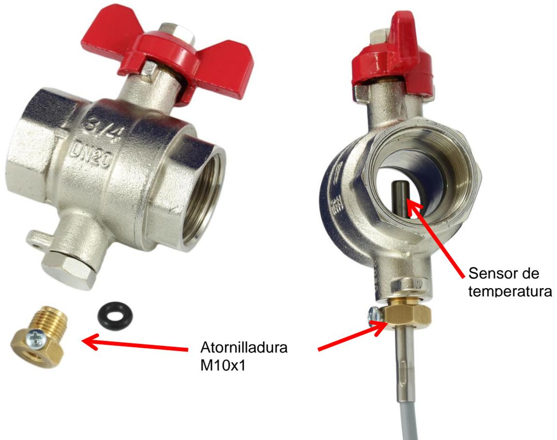
La llave esférica KH tiene enfrente de la palanca una atornilladura de montaje M10 x 1 para introducir un sensor de temperatura 01/BFPT1000 5x60MM, p. ej., para un calorímetro. La esfera tiene en este lugar una perforación para este sensor. De este modo, este se encuentra en el canal de flujo en medio de la esfera. Cuando se cierra, el sensor también se sella y se puede desmontar con facilidad (p. ej., para ser calibrado).
