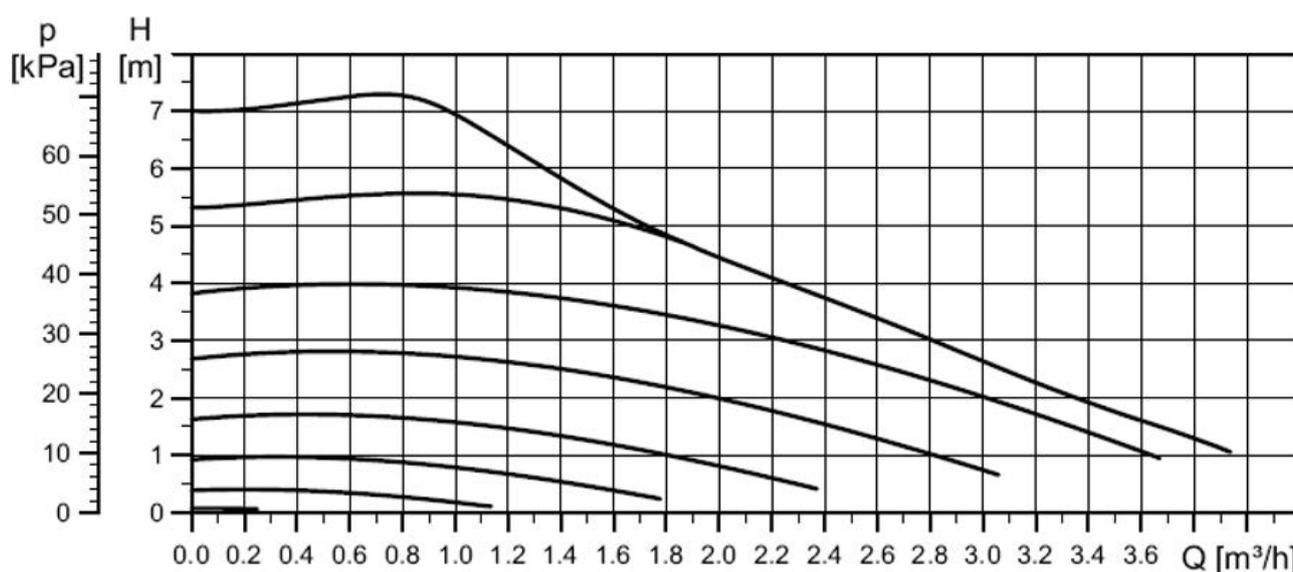
La pompa lavora in modalità riscaldamento, ovvero con valore PWM 5 % funziona a pieno numero di giri. L'interruzione della linea PWM determina quindi il pieno numero di giri della pompa.
