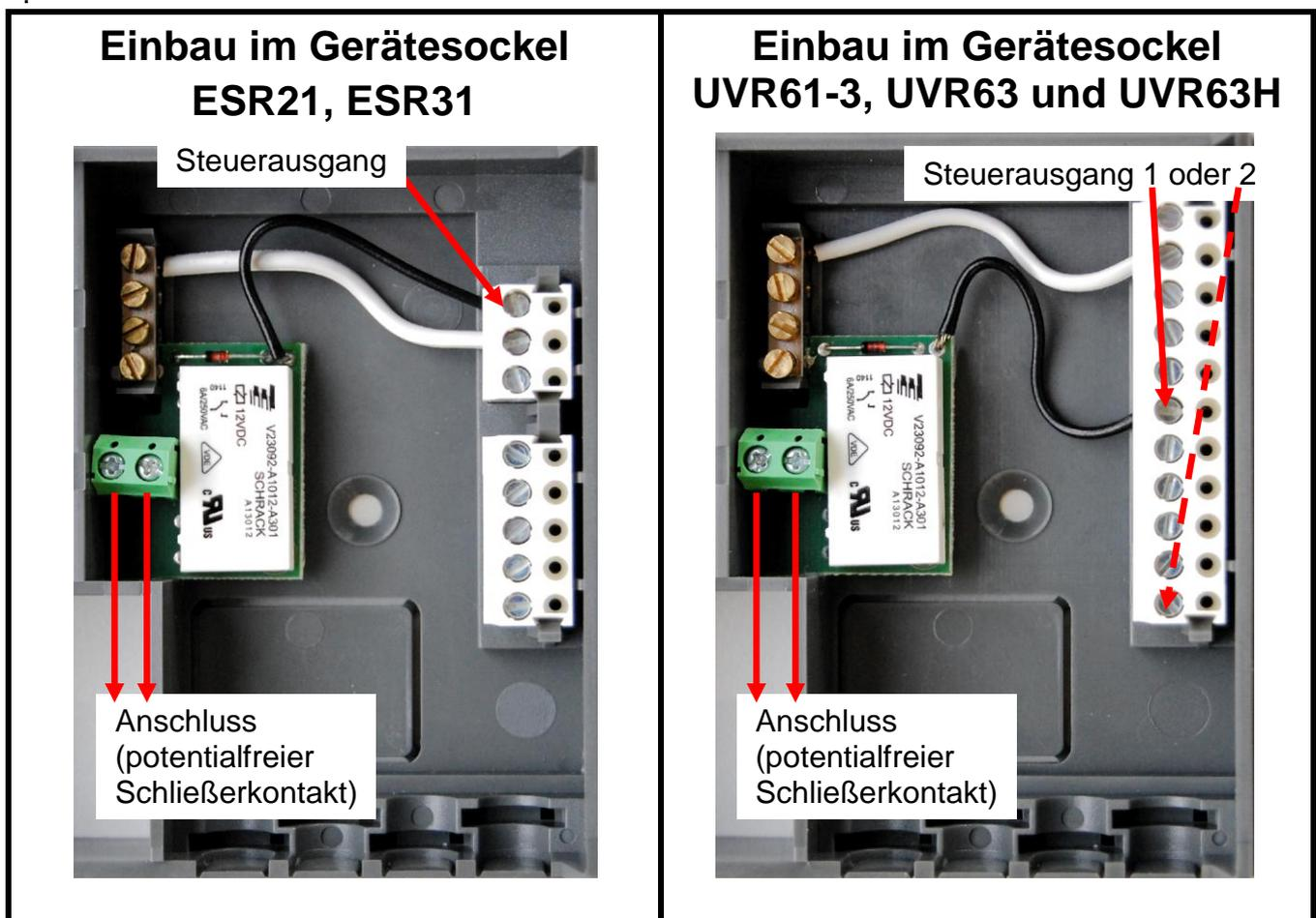
Das Relaismodul wird an die Sensormasse und einen Steuerausgang lt. obigen Bildern angeklemt. Für den Regler ESR31 ist die 4-pol. Masseleiste beige packt.
