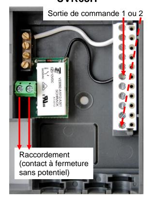
Le module relais est connecté à la masse du capteur et à une sortie de commande comme indiqué sur les figures ci-dessus. Pour le régulateur ESR31, le bornier-masse à 4 pôles est joint.
