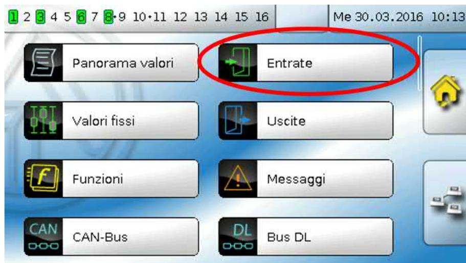
Selezionandole nel menu principale, le entrate vengono visualizzate con la relativa definizione e l'attuale valore di misura ovvero stato.
