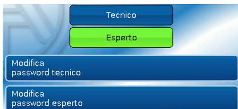
L'**Esperto** può modificare le password del livello Tecnico e del livello Esperto. Il **Tecnico** può modificare solo la password del livello Tecnico. La lunghezza della password e i tipi di caratteri utilizzati possono essere scelti a piacere.
