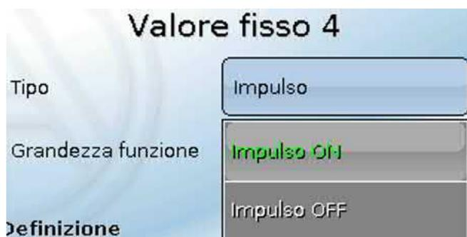
Selezione della **Grandezza funzione**: l'attivazione genera un impulso ON (da OFF a ON) o in maniera opzionale un impulso OFF (da ON a OFF).
