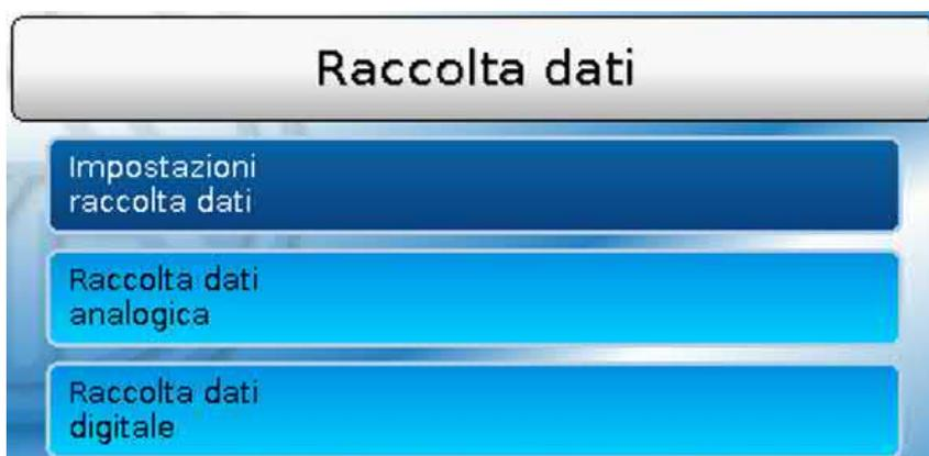
In questo menu vengono definite le impostazioni per la raccolta dati sul CAN-Bus o sulla scheda SD del regolatore per valori analogici e digitali.
