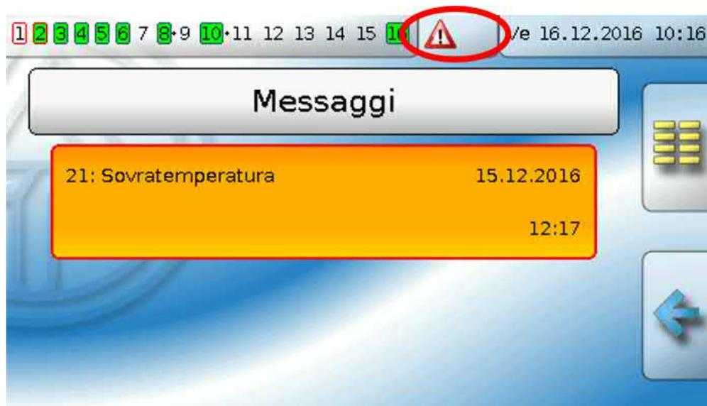
Se è attivo almeno un messaggio, nella riga di stato in alto viene visualizzato un triangolo di avvertenza.
