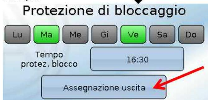
Il martedì e il venerdì alle 16:30 vengono attivate per 30 secondi le uscite selezionate in **Assegnazione delle uscite** se l'uscita non era attiva dall'avvio del modulo ovvero dall'ultima attivazione della protezione di bloccaggio.
