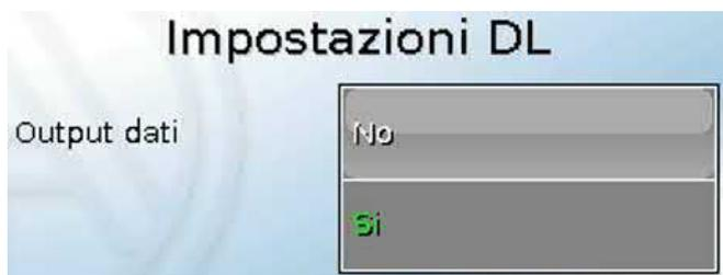
Con questi tasti è possibile attivare e disattivare l'**output** dati per la **raccolta dati** mediante bus DL e per le visualizzazioni nel sensore ambiente **RAS-PLUS**. Per la **Raccolta dati DL** si usa il C.M.I. Vengono indicati solo i dati di entrata e di uscita e 2 contatori della quantità di calore, ma nessun valore delle entrate di rete.
