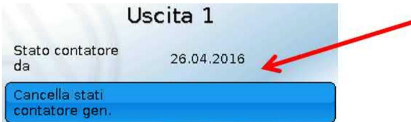
Dopo aver selezionato il pulsante, il sistema chiede se si desidera cancellare **tutti** gli stati dei contatori e il "**Giorno precedente**" del contatore delle ore di esercizio e del contatore impulsi. In questo modo gli stati dei contatori "**oggi**", "**Ultima corsa**" e "**Corsa attuale**" non vengono cancellati. A questa domanda si risponde selezionando il segno di spunta  (= sì) o la crocetta  (= no). Dopo la cancellazione viene visualizzata la data attuale.
