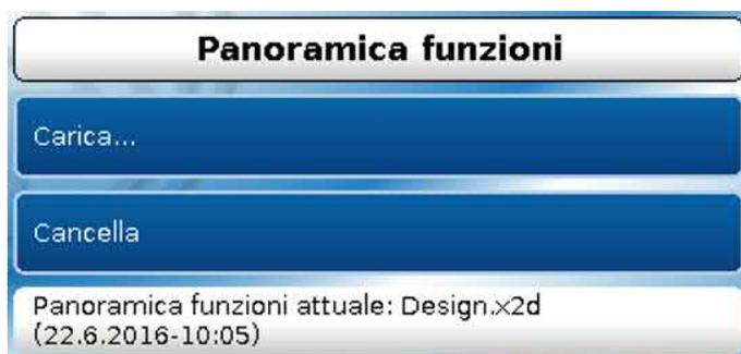
Dalla SD Card è possibile caricare o eliminare nell'apparecchio la panoramica delle funzioni (file .x2d, **versione minima TA-Designer: 1.15**). Sulla SD card possono essere memorizzati più file.
