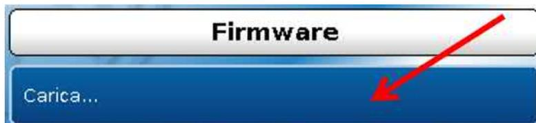
Dalla SD card è possibile caricare il firmware (= sistema operativo, file \*.bin) nel regolatore o in altri apparecchi x2 (eccezione: altri UVR16x2). Sulla SD card possono essere memorizzate più versioni del sistema operativo.
