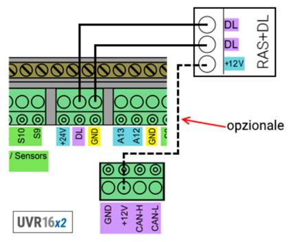
Come linea dati può essere utilizzato qualsiasi cavo con una sezione trasversale di 0,75 mm² (ad es.: trefolo gemello) fino ad una lunghezza max. di 30 m. Per cavi più lunghi consigliamo di utilizzare un cavo isolato.
