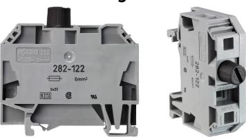
Die Sicherungsklemme SKL5x20 (samt 6,3A flink Sicherung) dient zur externen Absicherung des Reglers UVR610. Die interne Sicherung der UVR610 kann nur im Werk des Herstellers getauscht werden. Durch Anschluss der Sicherungsklemme an L1 wird die interne Sicherung des Geräts überbrückt. Die Sicherung in der Sicherungsklemme kann einfach vor Ort getauscht werden.
