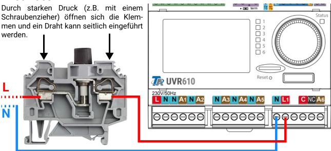
Die Sicherungsklemme wird an 11 angeschlossen. Die Richtung laut Anschlussgrafik muss beachtet werden (siehe Aufdruck "INPUT" an der Oberseite).
