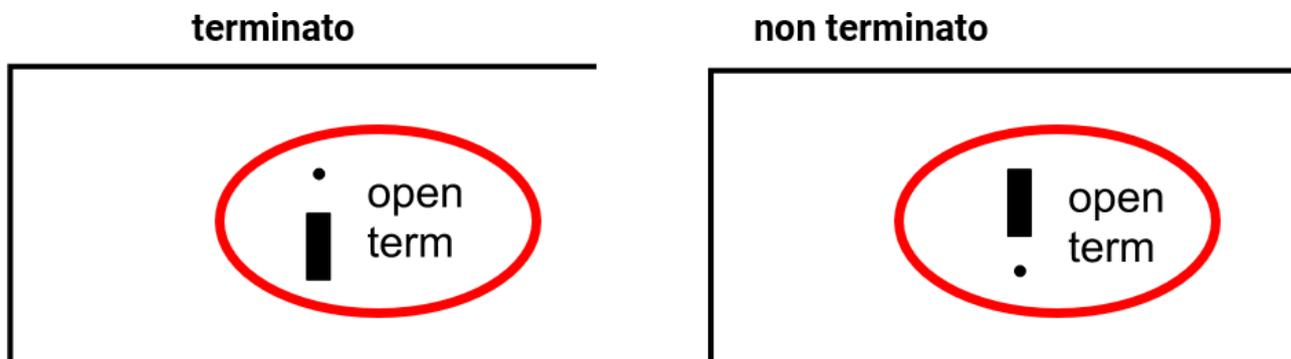
Il monitor CAN è terminato se il jumper è impostato sul lato della scritta "term" (come mostrato nella figura sopra).
