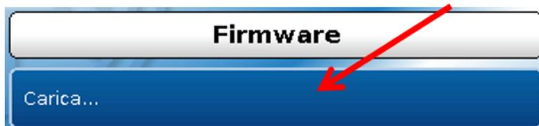
Dalla SD Card è possibile caricare il firmware (= sistema operativo, file \*.bin) nel monitor CAN o in altri apparecchi x2 nel CAN-Bus (**eccezione: UVR16x2**). Sulla SD card possono essere memorizzate più versioni del sistema operativo.
