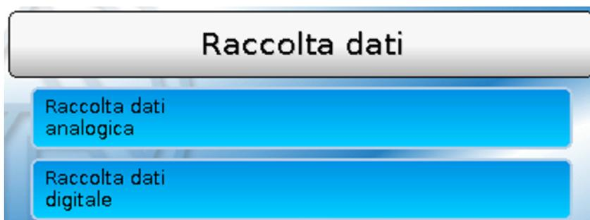
In questo menu vengono definiti i parametri per la raccolta dati CAN dei valori analogici e digitali.
