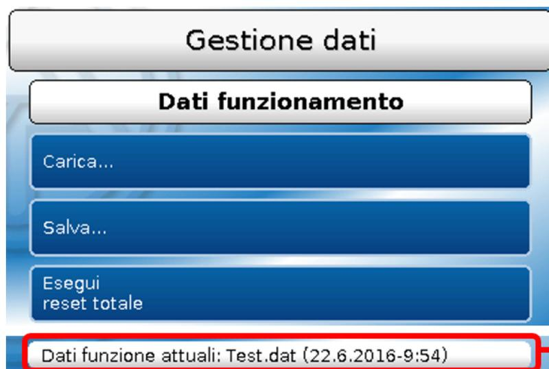
Visualizzazione di tutti i dati di funzionamento con indicazione dell'orario del caricamento
