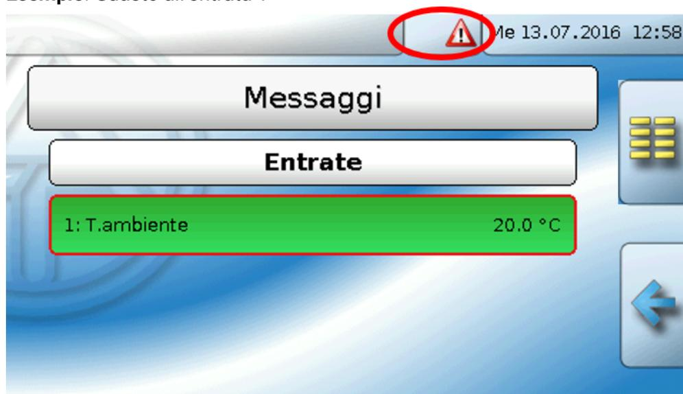
Se è attivo almeno un messaggio interno, nella riga di stato in alto viene visualizzato un triangolo di avvertenza **a destra**. Se la finestra dei messaggi è stata nascosta, è possibile visualizzarla di nuovo selezionando il **triangolo di avvertenza** nella barra di stato.
