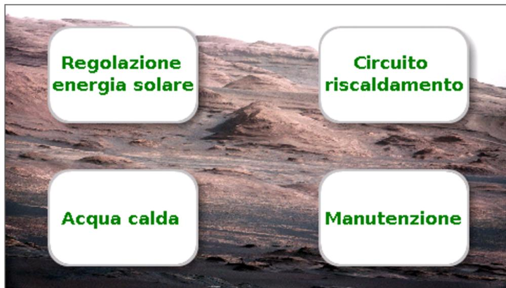
Se si tiene selezionata per 3 secondi l'immagine di sfondo compaiono 4 pulsanti, mediante i quali è possibile richiamare le informazioni sulla versione del monitor CAN, le impostazioni di base o le impostazioni per data, ora e sede, oppure accedere al menu principale del monitor CAN.
