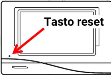
In casi particolari può rendersi necessario resettare il **firmware** del monitor CAN allo stato in cui era al momento della consegna. Contemporaneamente viene eseguito un reset totale.
