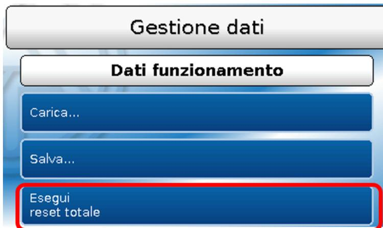
Il **reset totale** elimina tutte le impostazioni e ripristina il monitor CAN alle impostazioni di fabbrica. Le impostazioni per il numero di nodo CAN e del Bus rate CAN vengono mantenute.
