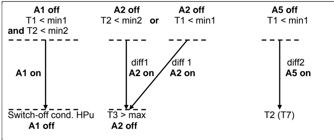
$$A2 = ((T1 > \text{min}1 \ \& \ T1 > T3 + \text{diff}1) \ \text{or} \ (T2 > \text{min}2 \ \& \ T2 > T3 + \text{diff}1)) \ \& \ T3 < \text{max}$$
