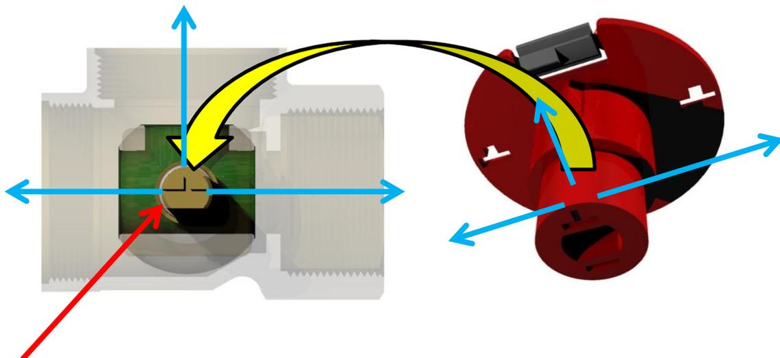
La **marca** del eje de la válvula muestra la posición de la válvula esférica.
