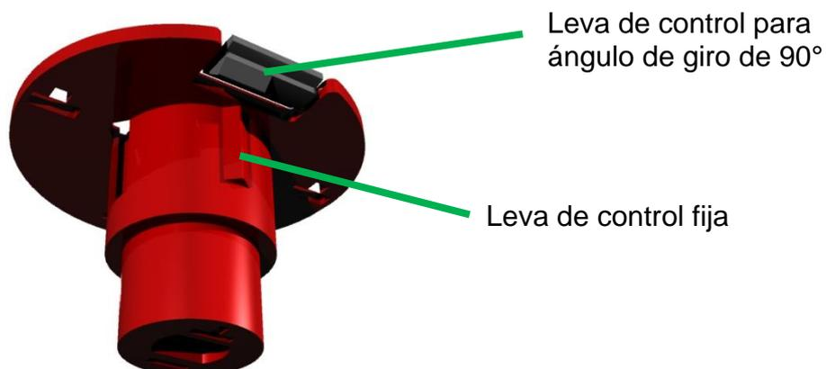
Si se desea un ángulo de conmutación de 90° hay que colocar otra leva de control en el eje. Para ello se saca la leva de control, la cual está marcada en gris en los dibujos, de la arandela y se mete en la ranura prevista para ello.
