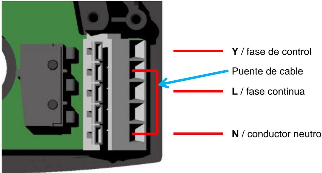
La conmutación también se puede realizar a través de una **tensión externa** si no se puede asegurar que la fase de control Y tenga el mismo ángulo de fase (L1, L2, L3) o que proceda del mismo circuito de corriente:
