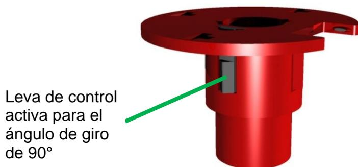
Si la leva de control que se ha sacado ya no se necesita, esta se puede meter en la ranura estando girada en un ángulo de 180° para que no conmute el interruptor de fin de carrera:
