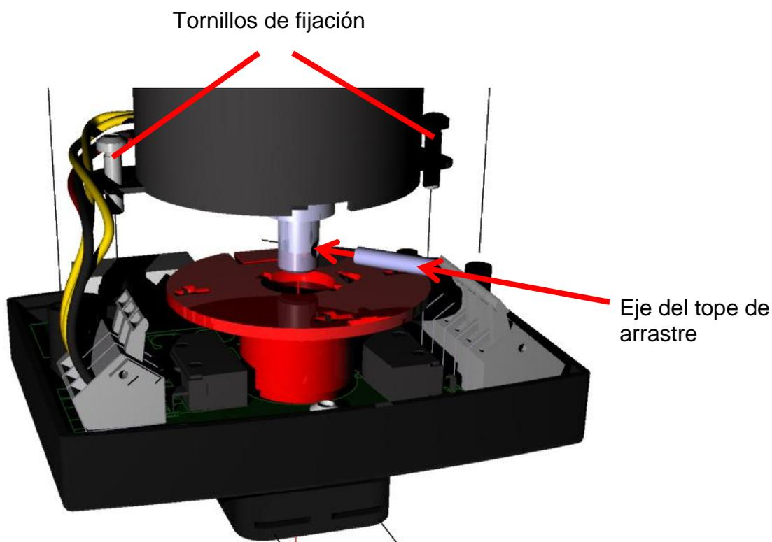
El motor ya viene montado de fábrica a los bornes del motor. Estas conexiones no se pueden cambiar.
