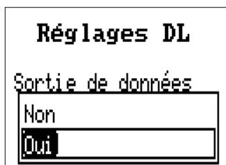
Ce bouton permet d'activer ou de désactiver la **sortie** de données pour l'**enregistrement de données** via le bus DL et pour les affichages dans le capteur ambiant **RAS+DL**. Le C.M.I. est utilisé pour l'**enregistrement de données** DL. Seules les valeurs d'entrée et de sortie ainsi que 2 calorimètres sont transmis, mais aucune valeur des entrées réseau.
