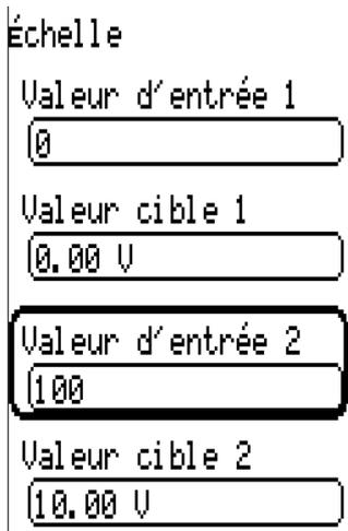
**Valeur de température**, d'une fonction analogique par ex. : mode MLI, la température 0 °C doit correspondre à 0%, la température 100,0 °C doit correspondre à 100% :
