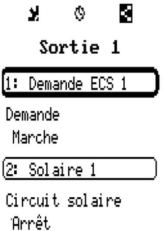
Dans cet exemple, la sortie 1 de 2 fonctions est commandée, cette sortie étant activée au même moment par la fonction 1 (eau chaude sanitaire).
