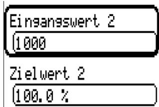
**Puissance de brûleur**, p. ex. des fonctions de demande d'eau chaude ou de maintenance : mode 0-10 V, la puissance de brûleur de 0,0% doit correspondre à 0 V et 100,0% à 10 V :
