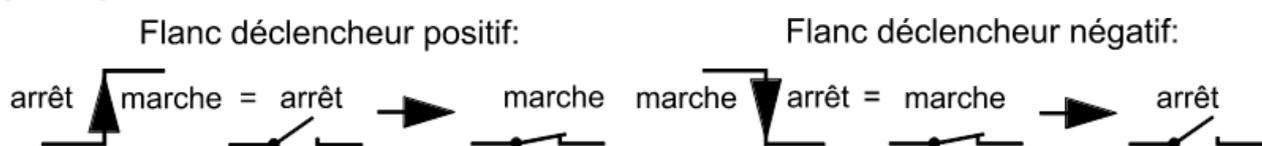
**Temps d'inertie :** Le signal MARCHÉ à l'entrée de déclenchement active **immédiatement** la sortie. Si l'entrée est désactivée (ARRÊT), la sortie reste sur MARCHÉ pour toute la durée du temps d'inertie.
