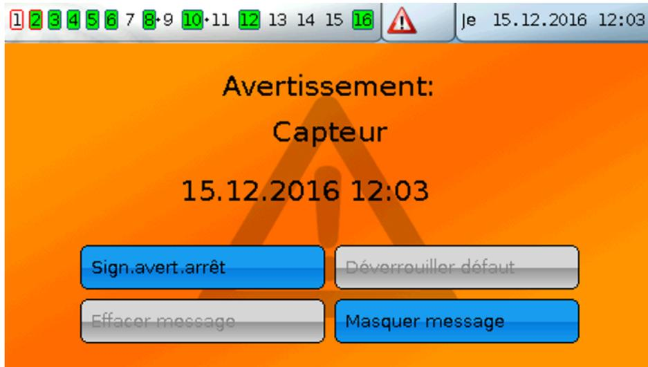
**Exemple** : Type de message **Message**, sortie 1 dominant ARRÊT, sortie 2 dominant MARCHE, signal d'avertissement activé, sortie pour signal d'avertissement : sortie 12.
