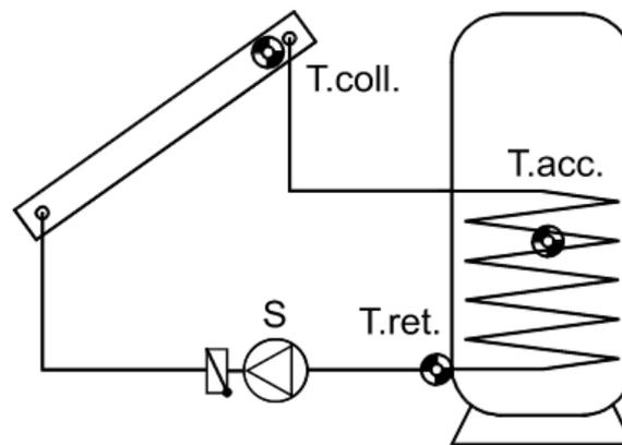
**Régulation par valeur absolue** = stabilisation d'un capteur
