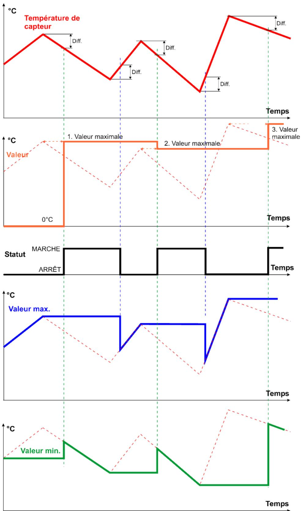
Graphique Détection flanc / Flanc positif / pas de signal de réinitialisation / quasi pic
