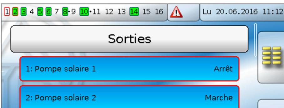
**Exemple** : Type de message **Erreur**, sortie 1 dominant ARRÊT, sortie 2 dominant MARCHÉ, signal d'avertissement activé, sortie pour signal d'avertissement : sortie 12.
