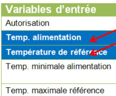
Si des capteurs optionnels ne sont pas utilisés, les valeurs de réglage correspondantes sont représentées **dans une autre couleur** et ne peuvent pas être paramétrées.
