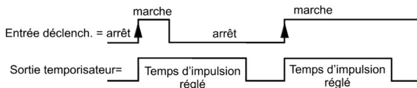
Un flanc de déclenchement **positif** est une modification de l'état d'entrée de « ARRÊT » à « MARCHÉ » ou de « Commutateur ouvert » à « Commutateur fermé » (= fermant). Cela correspond à l'exemple ci-dessus.
