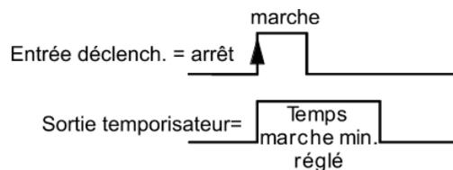
**Temps de blocage :** Le signal MARCHÉ à l'entrée de déclenchement réactive la sortie uniquement après l'expiration du temps de blocage depuis la fin du dernier signal MARCHÉ.
