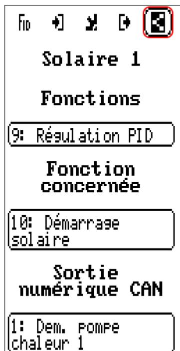
**Fonctions :** une variable de sortie de **Solaire 1** est liée avec une variable d'entrée de la fonction **Régulation PID**.
