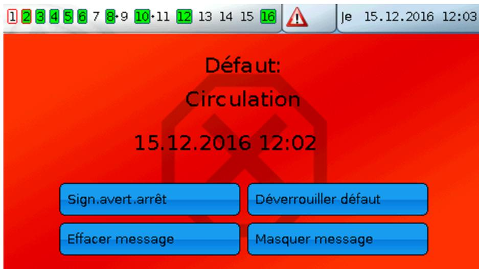
**Exemple** : Type de message **Avertissement**, sortie 1 dominant ARRÊT, sortie 2 dominant MARCHE, signal d'avertissement activé, sortie pour signal d'avertissement : sortie 12.
