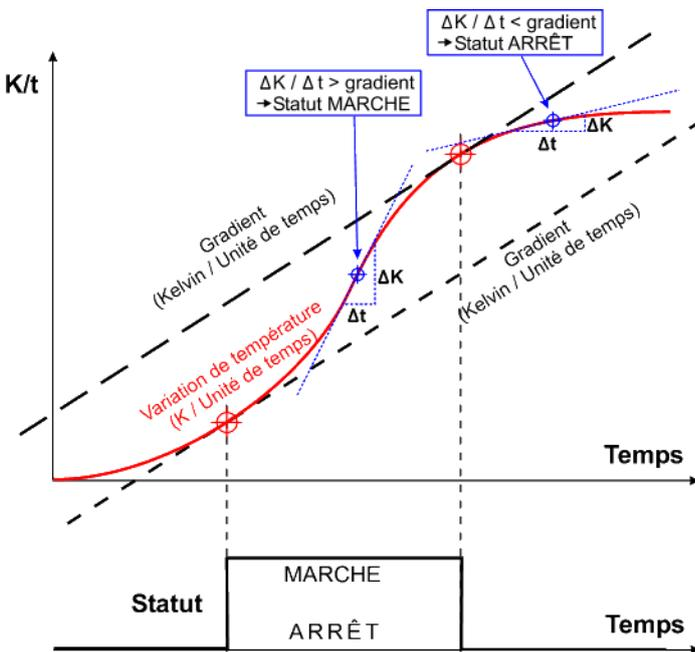
Le statut passe sur MARCHE si l'élévation de température est supérieure au gradient défini de max. un dixième de l'unité de temps définie.
