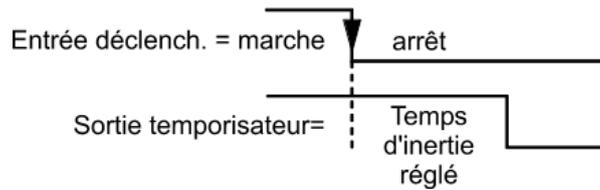
**Temporisation :** Le signal MARCHÉ à l'entrée de déclenchement est seulement transmis à la sortie à l'expiration de la temporisation. Le signal ARRÊT à l'entrée de déclenchement après expiration de la temporisation désactive immédiatement la sortie.
