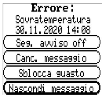
**Messaggio/avviso/guasto/errore:** tipo del messaggio visualizzato
