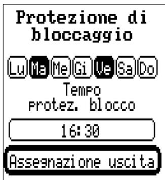
Il martedì e il venerdì alle 16:30 vengono attivate per 30 secondi le uscite selezionate in **Assegnazione delle uscite** se l'uscita non era attiva dall'avvio del modulo ovvero dall'ultima attivazione della protezione di bloccaggio.
