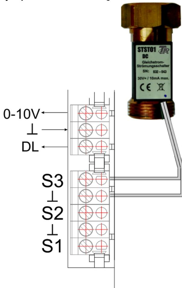
La conexión se realiza siempre en una entrada de sensor y la masa del sensor.
