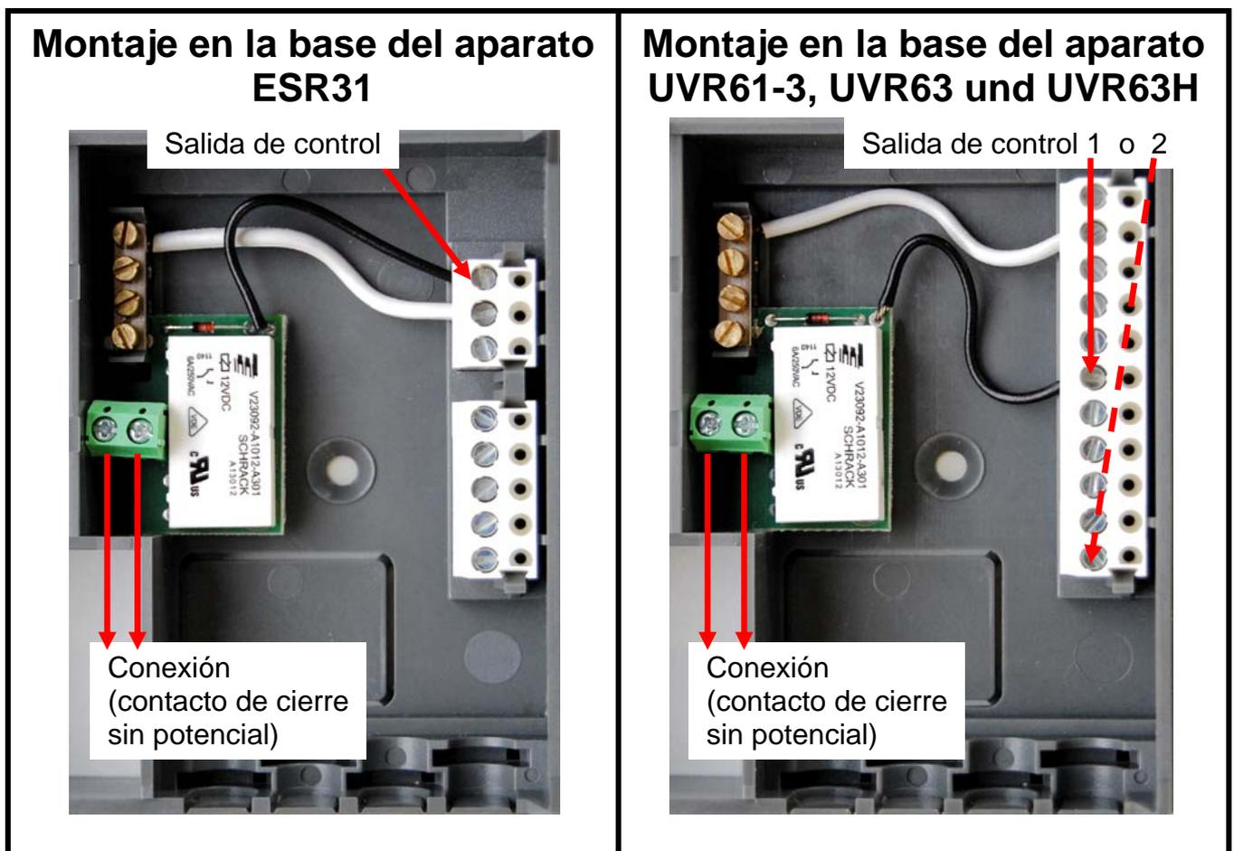
El módulo de relé se emborna a la masa del sensor y a una salida de control según la figura anterior. Para el regulador ESR31 se incluye en el embalaje la tira de toma de tierra de 4 polos. El contacto de cierre carece de potencial.
