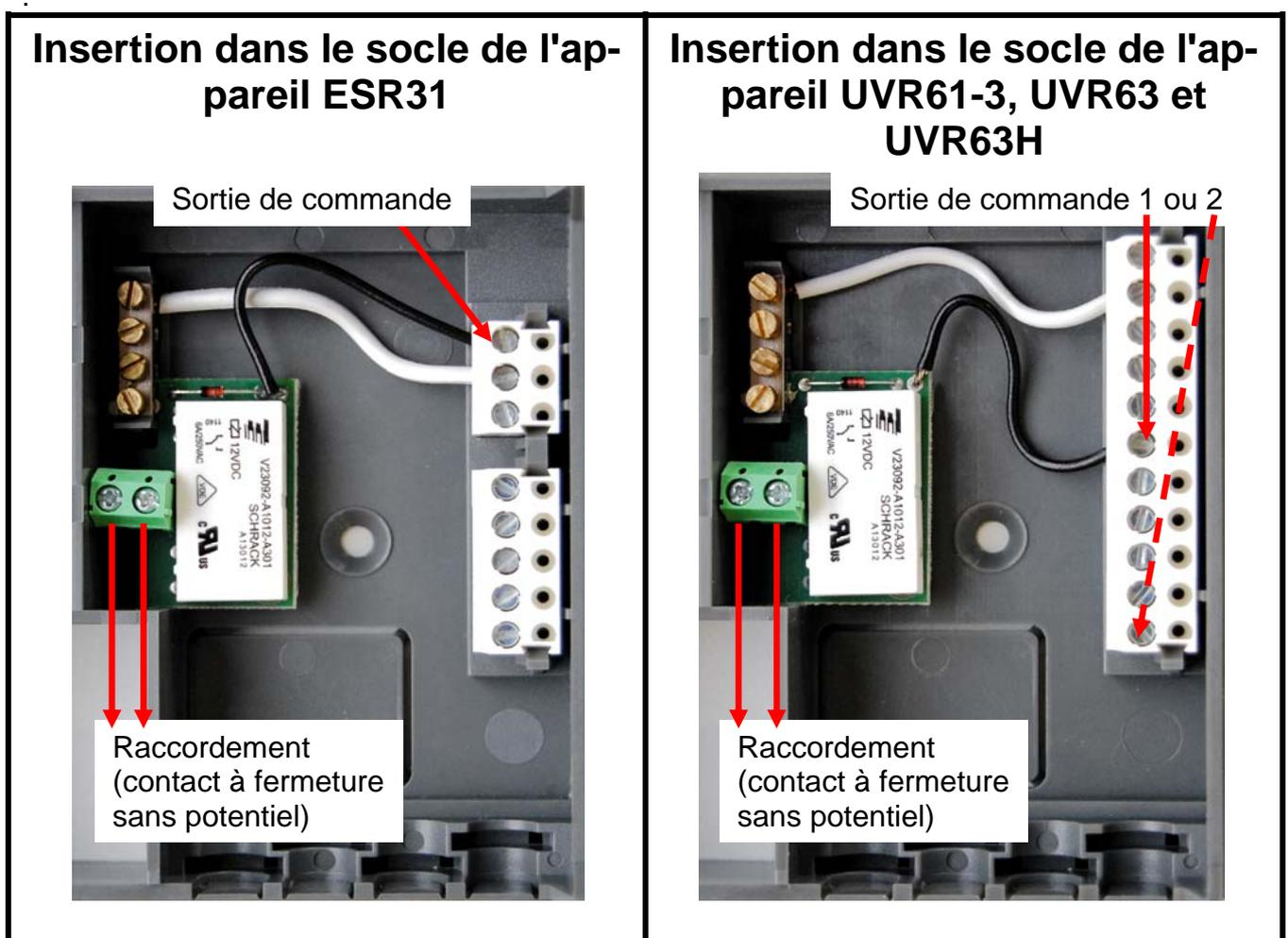
Le module relais est connecté à la masse du capteur et à une sortie de commande comme indiqué sur les figures ci-dessus. Pour le régulateur ESR31, le bornier-masse à 4 pôles est joint. Le contact à fermeture est sans potentiel.
