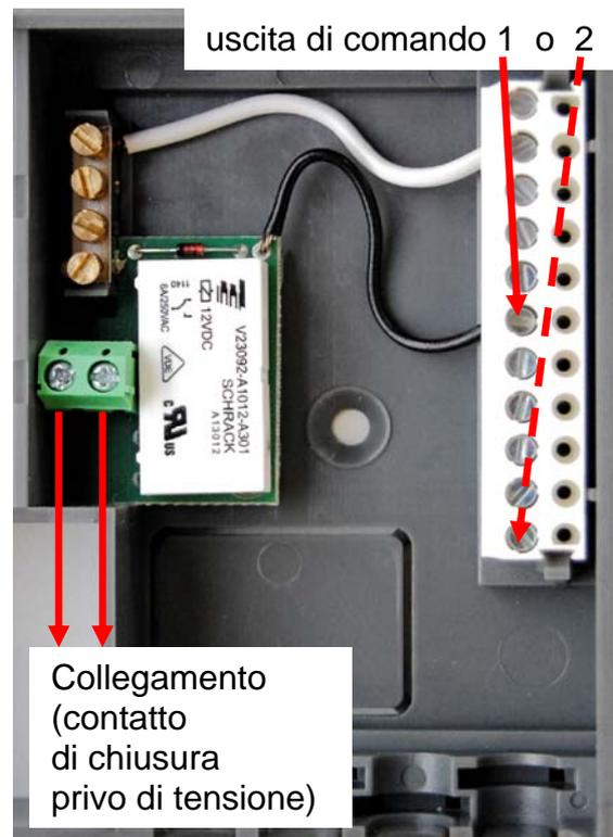
Il modulo relè viene collegato alla massa del sensore e ad una uscita di comando secondo le figure riportate in alto. Per il regolatore ESR31 è compresa nella fornitura la barra di massa a 4 poli. Il contatto di chiusura è privo di tensione.
