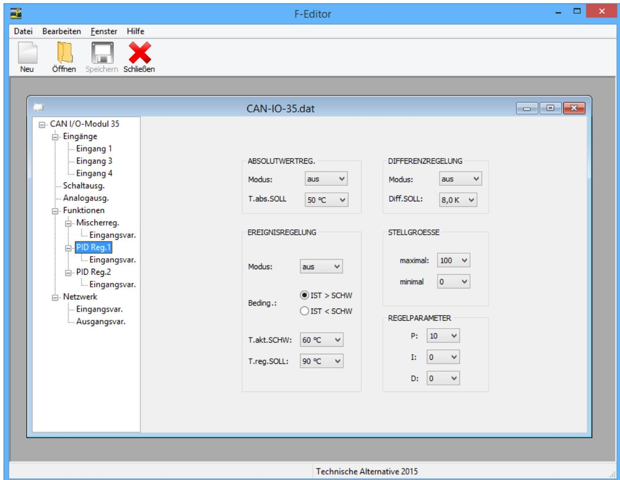
Das Programm Funktionsdaten Editor (F-Editor) ermöglicht das Erstellen und Bearbeiten der Konfiguration (Funktionsdaten) der Geräte CAN-Monitor, CAN-I/O, CAN-BC, BL-NET und CAN-EZ. Diese neu erstellten bzw. bearbeiteten Funktionsdaten können anschließend mittels C.M.I. oder mittels Bootloader und Memory Manager auf das Gerät geladen werden.
