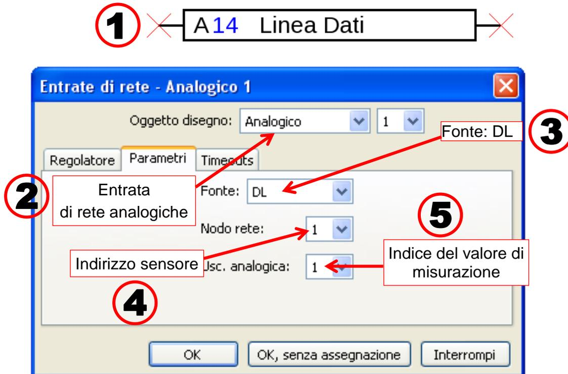
Per ogni nuovo valore è necessario selezionare una variabile di entrata di rete non ancora utilizzata.
