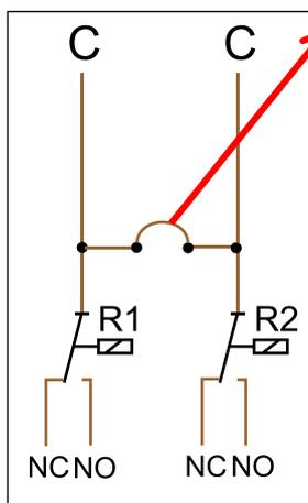
**Perçage** : Les contacts du relais sont - **sans** liaison **x)** - libres de potentiel, les deux racines (**C**) étant reliées en usine. Grâce au perçage du **trou** entre les deux relais à un diamètre d'au moins **6 mm**, le potentiel des deux sorties est séparé conformément aux normes.
