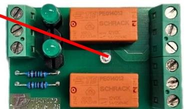
Le relais auxiliaire peut être raccordé à deux sorties analogiques, si celles-ci sont paramétrées en tant que **sorties de commutation**.
