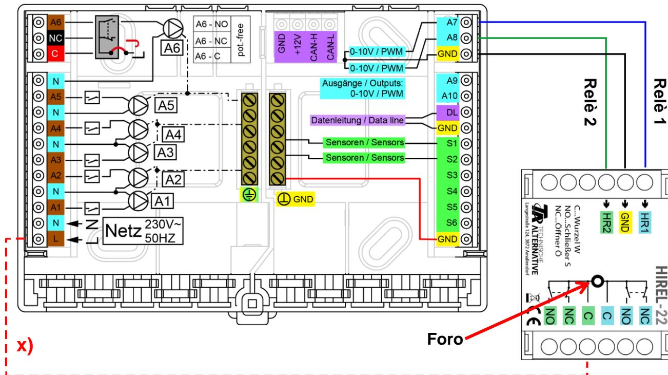
**x)** Questo collegamento permette di collegare i contatti relè con il conduttore esterno (230 V). In questo modo le uscite relè non sono più senza potenziale.
