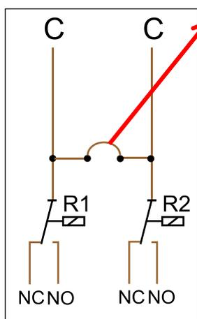
**Foro:** I contatti relè - **senza collegamento x)** - sono senza potenziale, dove le due origini (C) sono collegate in fabbrica. Praticando tra i due relè un foro di diametro minimo 6 mm, viene separato il potenziale tra le due uscite, come prescritto dalla normativa.
