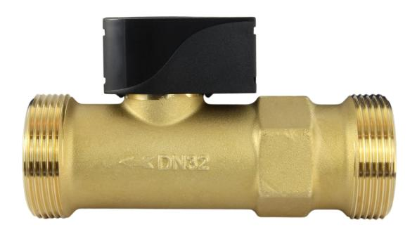
Die elektronischen Volumenstromsensoren FTS....DL basieren auf dem Prinzip der Karman'schen Wirbelstraße. Die Wirbelablösung an dem in der Strömung stehenden Staukörper erfolgt streng proportional zur Strömungsgeschwindigkeit. Die erzeugten Wirbel werden durch ein piezoelektrisches Paddel detektiert und durch die integrierte Elektronik ausgewertet. Ein Mikroprozessor wandelt die analogen Messwerte in ein für den DL-Bus (Datenleitung) geeignetes serielles Digitalsignal um.
