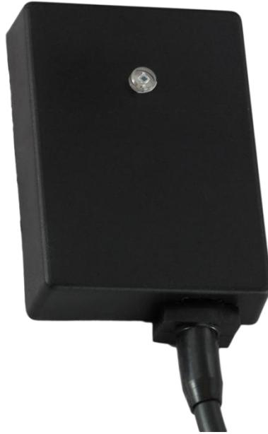
Le capteur de rayonnement GBS01 a été conçu pour le captage du rayonnement solaire en liaison avec les régulateurs UVR. Ce capteur facilite le démarrage de l'installation et permet une commutation plus exacte au récepteur prioritaire dans les installations solaires à circuits multiples. En cas d'utilisation de deux capteurs, il est possible de créer un système de poursuite du soleil pour les capteurs. À cause de sa précision il peut également être utilisé pour des fins de mesurage seulement.
