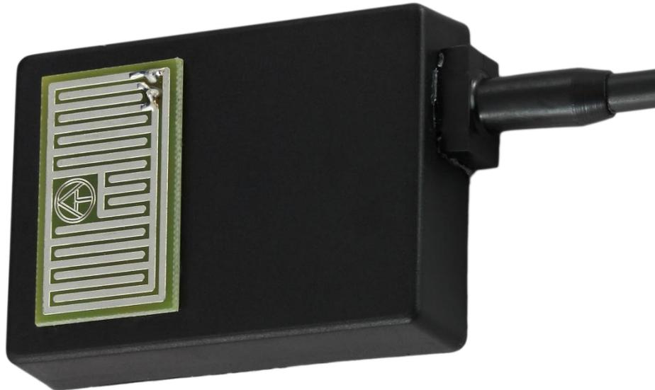
Der Regensensor RES01 wurde für witterungsgeführte Regelaufgaben (z.B. Öffnen und Schließen von Wintergartenfenstern) entwickelt. Der integrierte Messverstärker wandelt das Sensorsignal in einen Temperaturwert um. Die Trockentemperatur beträgt ca. 90°C. Diese kann durch Verschmutzung etwas sinken. Die Feuchteschwelle sollte ca. 20°C unter der angezeigten Trockentemperatur definiert werden.
