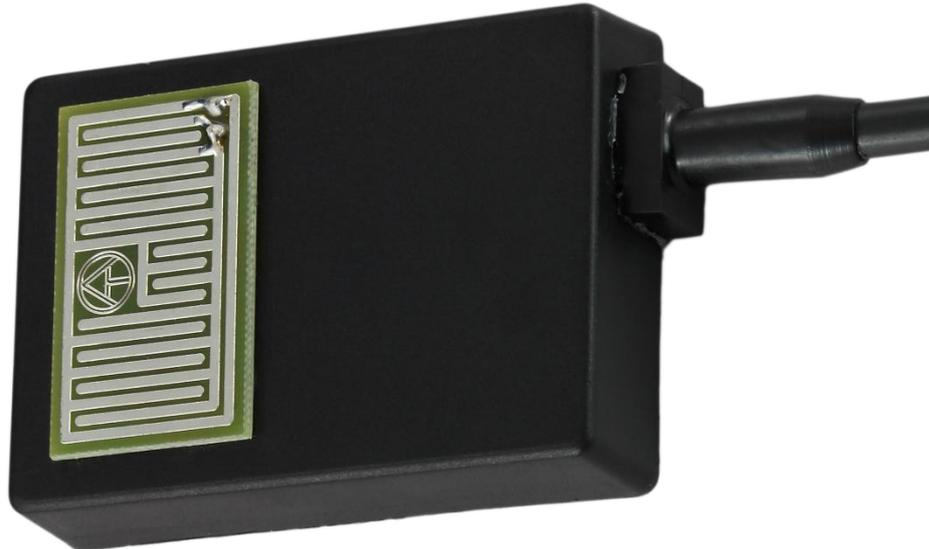
Il sensore pioggia RES01 è stato studiato per funzioni di regolazione legate alle condizioni meteorologiche (ad es. l'apertura e la chiusura delle finestre di una serra). L'amplificatore di misura integrato trasforma il segnale del sensore in un valore di temperatura. La temperatura dell'aria secca è circa 90°C e può diminuire in caso di inquinamento. La soglia di umidità dovrebbe essere definita circa 20°C sotto la temperatura dell'aria secca visualizzata.
