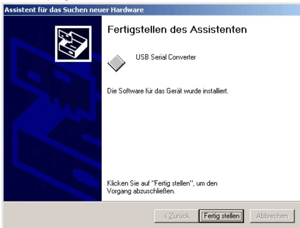
8. Der Hardware-Assistent fährt mit der Installation des Treibers für den virtuellen COM-Port (*USB Serial Port*) fort. Dieser Treiber wird in derselben Vorgangsweise wie der Treiber zuvor installiert.
