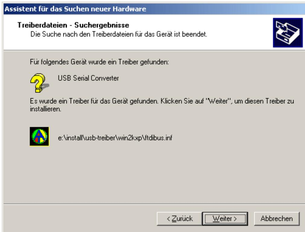
7. Mit "Fertig stellen" wird die Installation des Treibers für den USB-Controller (*USB Serial Converter*) abgeschlossen.
