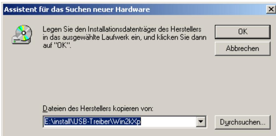
12. Mit "Durchsuchen" kann der entsprechende Pfad und die für die Installation benötigte .INF-Datei ausgewählt werden. Für die Installation des virtuellen COM-Ports <USB Serial Port> muss die Datei „ftdiport.inf“ ausgewählt werden!
