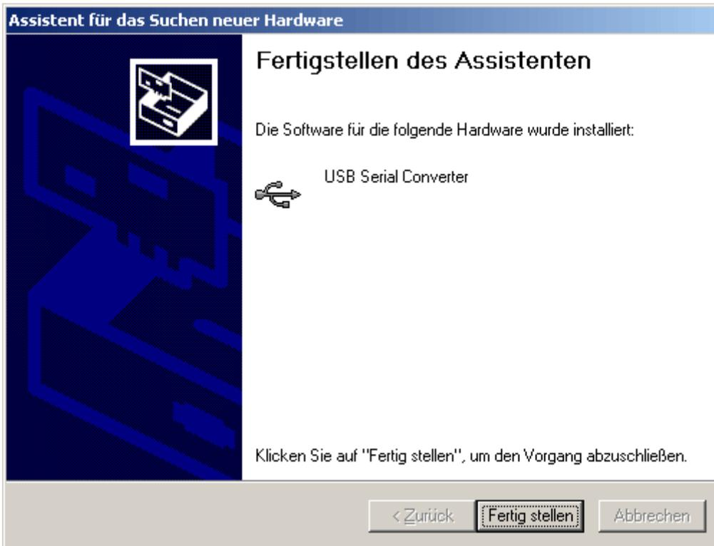
6. Der Hardware-Assistent fährt mit der Installation des Treibers für den virtuellen COM-Port (*USB Serial Port*) fort. Dieser Treiber wird in derselben Vorgangsweise wie der Treiber zuvor installiert.
