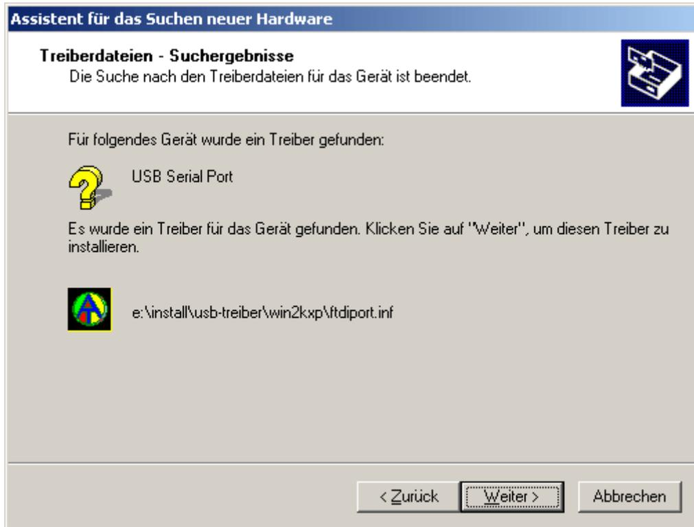
14. Nach erfolgter Installation des Treibers für den virtuellen COM-Port (*USB Serial Port*) wird mit "Fertig stellen" die Installation aller erforderlichen Komponenten für eine Kommunikation via USB abgeschlossen.
