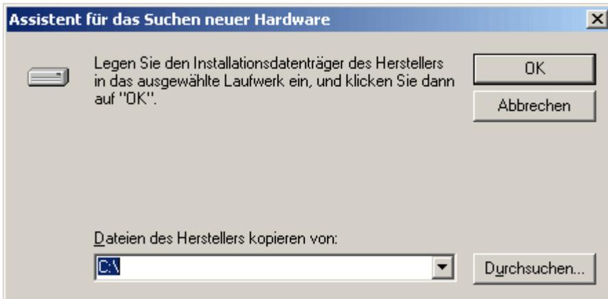
5. Mit "Durchsuchen" kann der entsprechende Pfad und die für die Installation benötigte .INF-Datei ausgewählt werden. Für die Installation des USB-Controller <**USB Serial Converter**> muss die Datei „ftdibus.inf“ ausgewählt werden!
