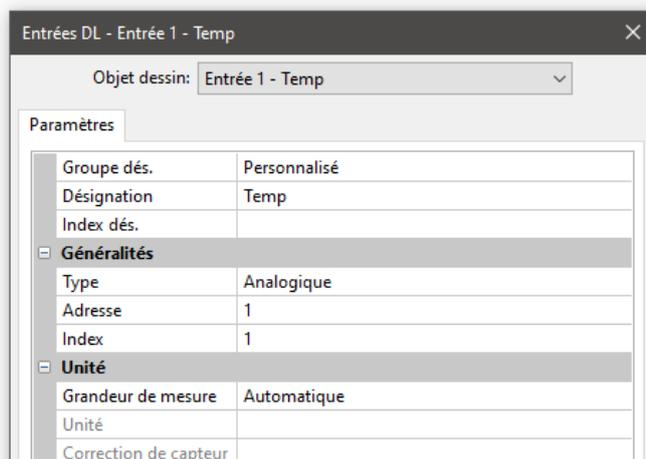
Les réglages les plus importants se trouvent à la rubrique **Généralités**. L'adresse de bus DL paramétrée sur UMV5-DL (usine 1) doit y être indiquée, ainsi que l'index de l'entrée souhaitée.
