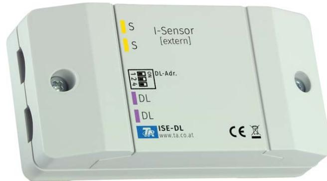
Mit diesem Messverstärker kann mittels dem mitgelieferten externen Stromwandler der Effektivstrom (RMS) beliebiger Verbraucher bis 50A gemessen werden. Der gemessene Strom wird für den DL-Bus übersetzt.
