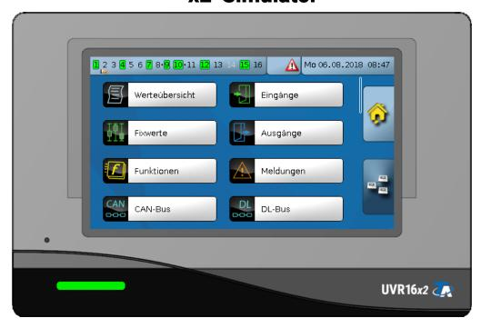
Der x2-Simulator zeigt exakt die gleiche Displayansicht des Reglers UVR16x2. Alle Aktionen können wie am Regler selbst durch Mausklick durchgeführt werden.
