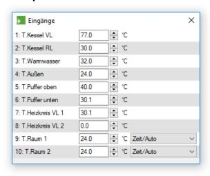
Um Werte zu ändern, kann ein gewünschter Wert eingegeben oder die Pfeile geklickt werden. Um ein eine Sensorunterbrechung oder einen Kurzschluss zu simulieren, muss die Temperatur des Sensors so eingestellt werden, dass die jeweiligen Grenzen erreicht werden. RAS-Sensoren haben außerdem die Möglichkeit einer Betriebsartenumschaltung. Bei einem Neustart des Simulators werden die **zuletzt** simulierten Eingangszustände angezeigt.
