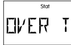
Colector desconexión de exceso de temperatura está activada (no se ha producido ningún error)
