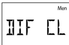
Effacer ajustage des capteurs
