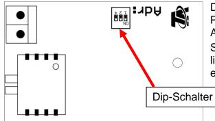
Die **Adresse** wird mit den Dip-Schaltern auf der Platine eingestellt. Im Auslieferungszustand ist die Adresse auf 1 eingestellt (Werkseinstellung).
