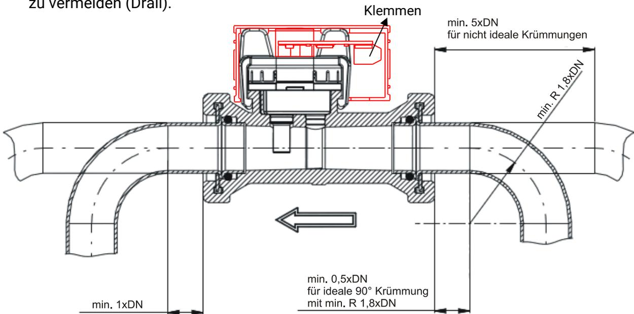
**Die Flussrichtung ist unbedingt zu beachten** (am Sensor durch einen Pfeil gekennzeichnet). Die Einbaulage ist beliebig.
