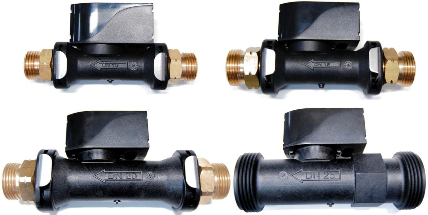
Die elektronischen Volumenstromsensoren FTS....DL basieren auf dem Prinzip der Karman'schen Wirbelstraße. Die Wirbelablösung an dem in der Strömung stehenden Staukörper erfolgt streng proportional zur Strömungsgeschwindigkeit. Die erzeugten Wirbel werden durch ein piezoelektrisches Paddel detektiert und durch die integrierte Elektronik ausgewertet. Ein Mikroprozessor wandelt die analogen Messwerte in ein für den DL-Bus (Datenleitung) geeignetes serielles Digitalsignal um.
