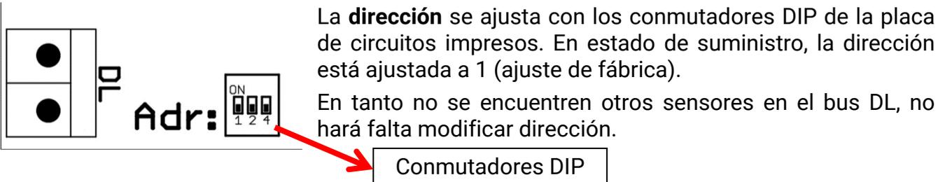
La dirección efectiva resulta de la dirección 1 (= ajuste de fábrica) y la suma de todos los valores de las posiciones DIP seleccionadas.
