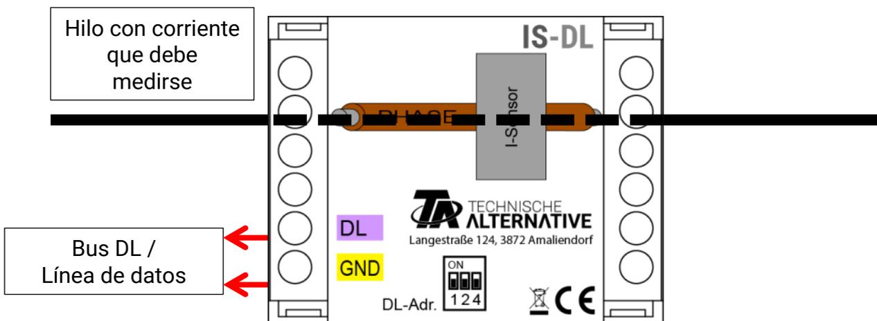
La polaridad de las conexiones **bus DL** es **intercambiable** y no debe tenerse en cuenta.
