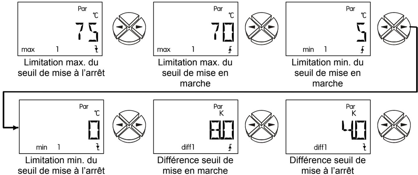
**max ↓** A partir de cette température sur le capteur correspondante, la sortie est bloquée. (RU = 75°C) (RU = réglage usine)
