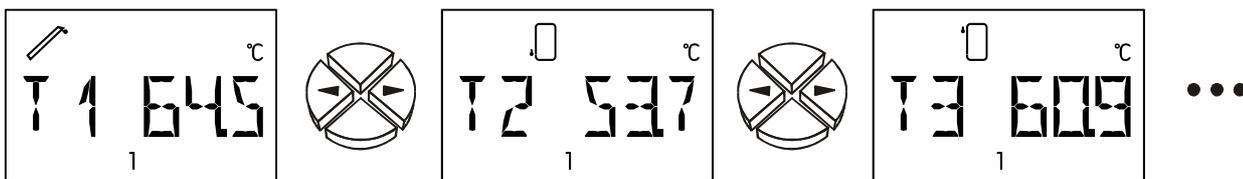
Les sorties actuellement actives sont reconnaissables aux chiffres 1 à 3 de couleur verte situés sur le côté de l'écran. Lorsque la régulation de la vitesse de rotation est active, le affichage de la sortie 1 clignote alors en fonction du niveau de vitesse de rotation.
