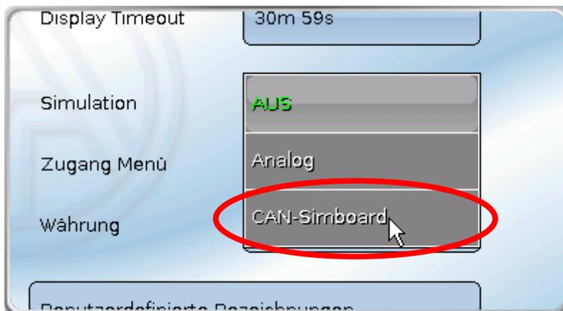
Ein in einem CAN-Netzwerk werden die simulierten Temperaturen von **allen** X2-Geräten übernommen, in denen die Simulation auf „**CAN-Simboard**“ eingestellt ist.
