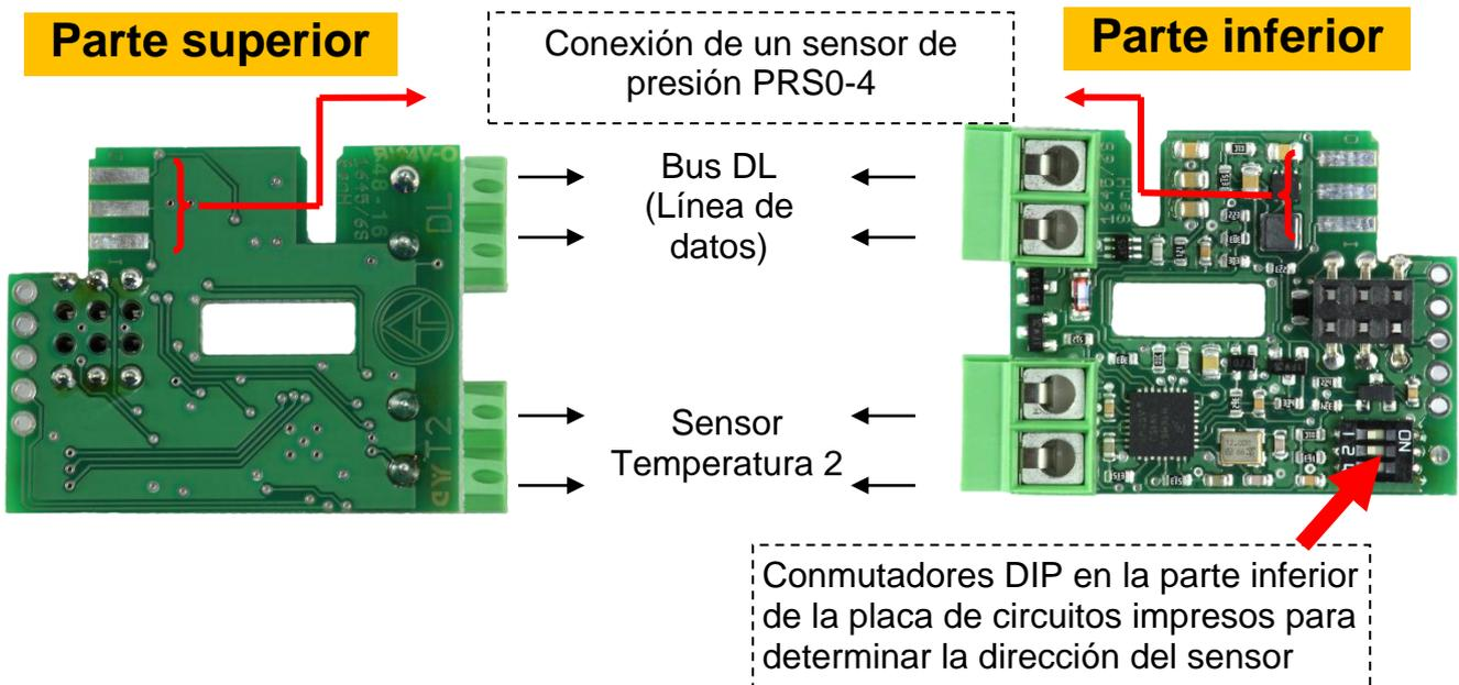
La respectiva polaridad de las conexiones («masa») es intercambiable y no debe tenerse en cuenta.
