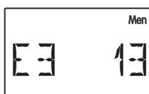
aquí se ha asignado al sensor externo **E3** el valor de sensor de la **dirección 1** con el **índice 3**, que es el valor de un sensor de temperatura PT1000 conectado al sensor FTS.
