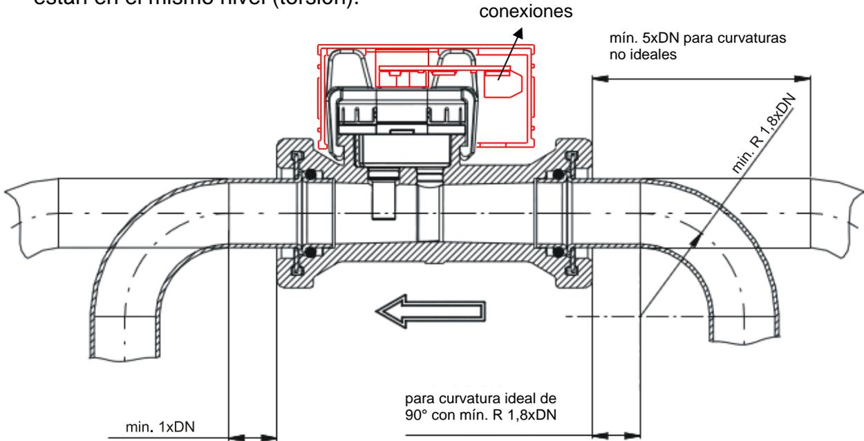
Es imprescindible tener en cuenta la **dirección del flujo** (identificada en el sensor mediante una flecha). El montaje se realiza en el lugar deseado. Las piezas de latón se pueden sacar retirando el clip de retención. Si se encajan de nuevo las atornilladuras en el componente del sensor se recomienda humedecer con jabón los anillos de obturación para mejorar la capacidad de deslizamiento.
