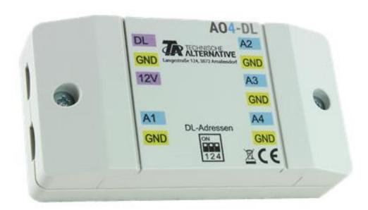
Le module **AO4-DL** (« AO » = analogue output) autorise 4 sorties analogiques supplémentaires pour les appareils dotés de la technologie X2 (UVR16x2, RSM610, CAN-I/O45 p. ex.).
