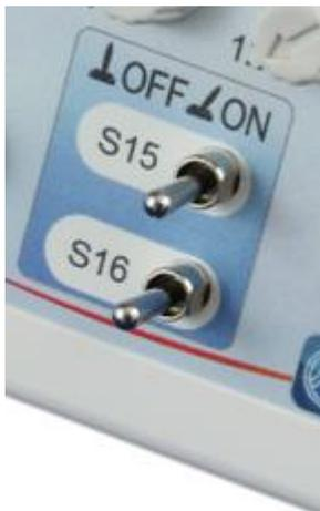
Mediante i due **commutatori** per le **entrate 15 e 16** è possibile simulare queste entrate come entrate di temperatura analogiche o entrate digitali **a seconda della rispettiva programmazione**.
