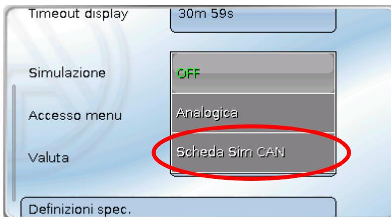
Le temperature simulate di **tutti** gli apparecchi X2 in cui è impostata la simulazione "**Scheda Sim CAN**" vengono rilevate in una sola rete CAN.
