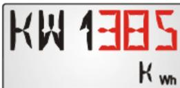
Gezählte Wärmemenge des Wärmemengenzählers 1 in kWh. Bei dreistelligen Anzeigen blinken „KW1“ und der Wert „385“ abwechselnd.
