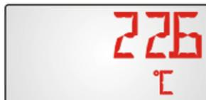
Temperaturanzeige am Externen Sensor 1, „EXT1“ und „22,6°C“ blinken abwechselnd.
