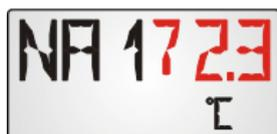
Aktueller Wert des analogen Netzwerkeinganges 1. Bei 3-stelligen Werten blinken „NA1“ und der Wert „72.3“ abwechselnd.
